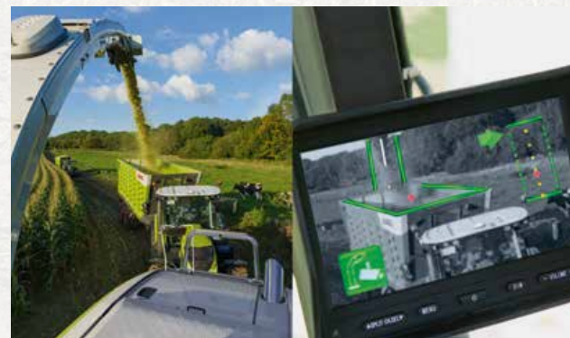
AUTO FILL na automatické plnenie odvozového prostriedku.
