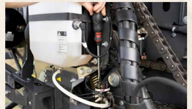
Permanentné mazanie reťazí.
